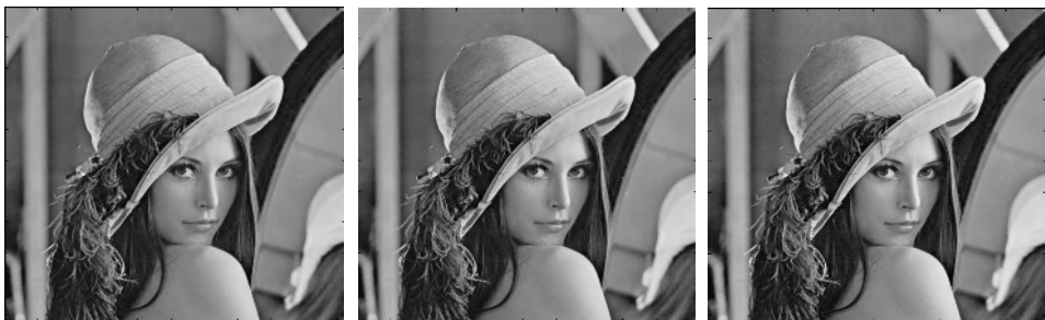
(d) Ratio = 90.63%; PSNR = 37.74 dB MSSIM = 0.93
